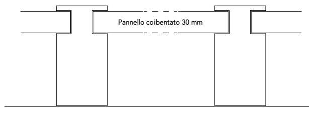
\* Lo spessore dei pannelli sandwich varia a seconda dei valori statici e dalle norme SIA relative al carico.
