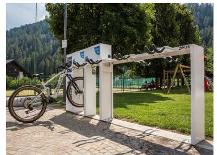
Kombiniert mit den 'Block'-Modulen wird daraus eine Ladestation, die 3 bis 10 Leichtfahrzeuge gleichzeitig aufnehmen kann.
