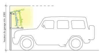
Bike Lift vous permet d'éviter les efforts physiques : les objets sont placés au niveau du sol et soulevés manuellement au moyen d'un système de poulies.
