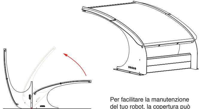
Per facilitare la manutenzione del tuo robot, la copertura può ruotare sul perno posteriore di fissaggio.
